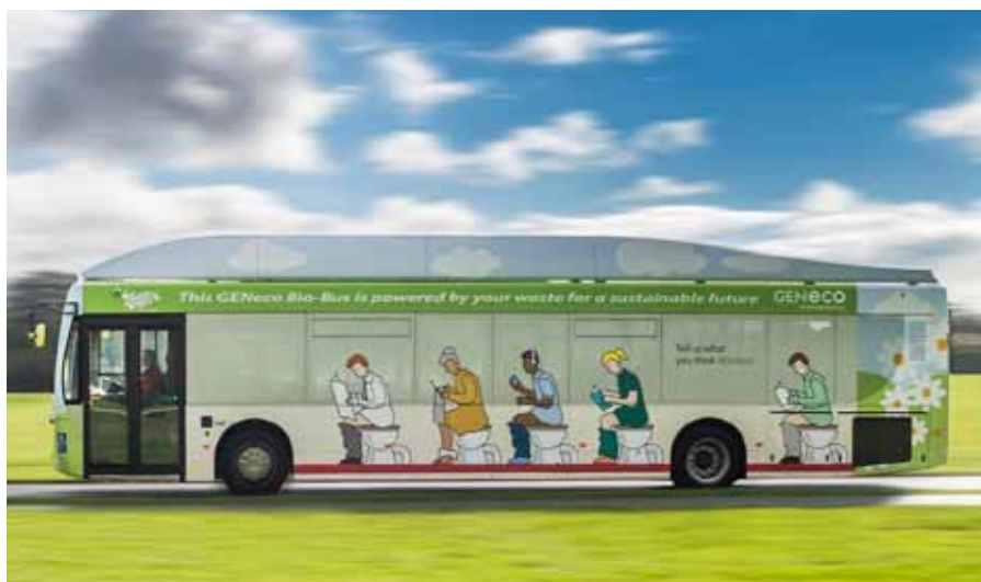
El Bio-bus de Bristol, un bus que funciona amb gas metà que és generat per excrements i restes de menjar.
